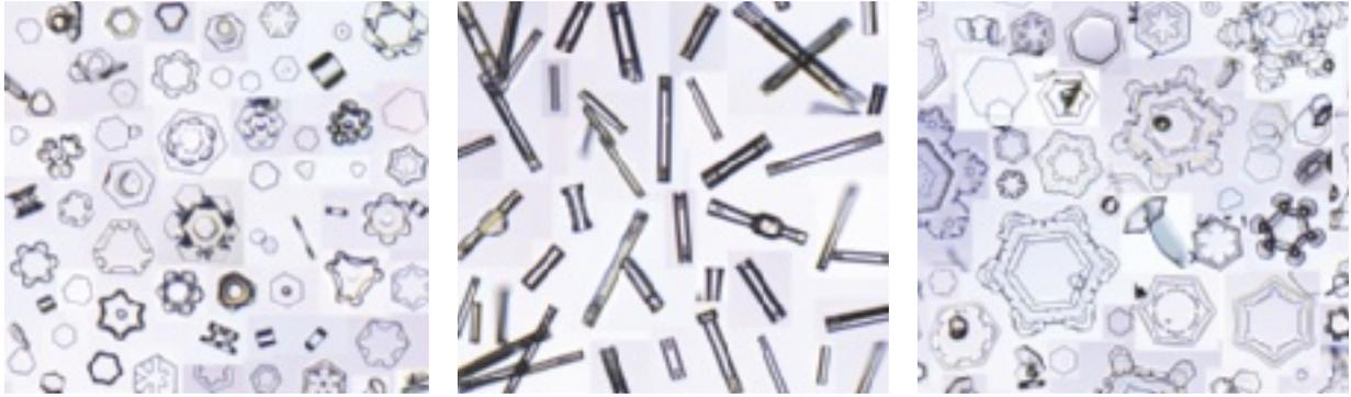
**3. La relation entre forme et température** mise en évidence par le diagramme de morphologie des cristaux de neige peut être illustrée en produisant des cristaux de neige en laboratoire. Ces petits cristaux
